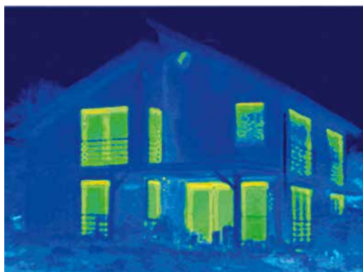
Nach dem sorgfältigen Einbau neuer Fenster aus dem Schüco LivIng Fenstersystem beweist die Thermografie den hohen energetischen Nutzen der Investition. Der ursprüngliche Energieverlust wird nahezu vollständig vermieden.
