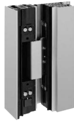
Verdeckt liegendes Türband, dreidimensional einstellbar, max. Öffnungswinkel 100°,
